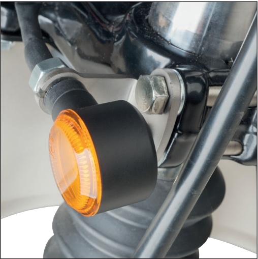
L'illustration montre un support de clignotant brut
