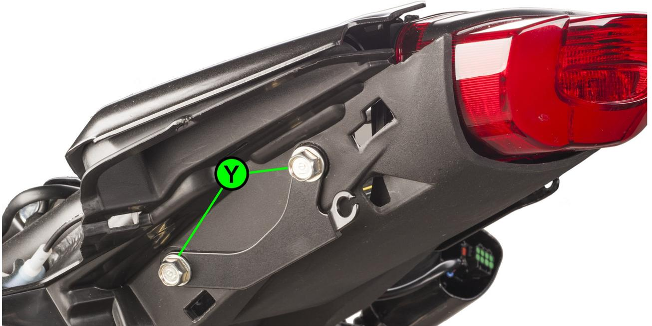
**DE** Die Blinkerhalter mit den vier OEM-Schrauben (Y) am Rahmenheck montieren.
