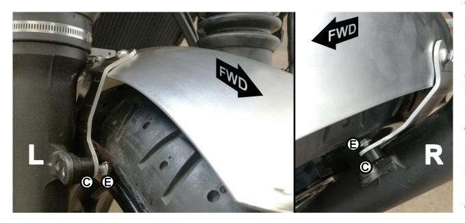
Die Sechskantschrauben (E) und die Distanzbuchsen (C) können schon vor dem "Aufsetzen" des Kotflügels in die gezeigten Positionen gebracht werden. Anschließend den Kotflügel über den Reifen schieben und die Schrauben lose in das hintere der beiden vorderen Gewindelöcher einschrauben.
