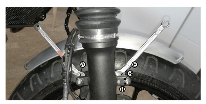
Den Kotflügel ausrichten und alle vier Befestigungen - hinten die Kontermuttern (A) und vorne die Sechkantschrauben (E) - von innen mit einem Maulschlüssel festziehen. Anschließend auf beiden Seiten die Schrauben (H) inkl. U-Scheibe (E) in das vordere Gewindeloch einschrauben (dient als Blende).
