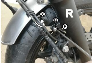
Die Schraube (G) mit einer U-Scheibe (B) versehen und in die hintere Befestigung der linken Seite eindrehen.
