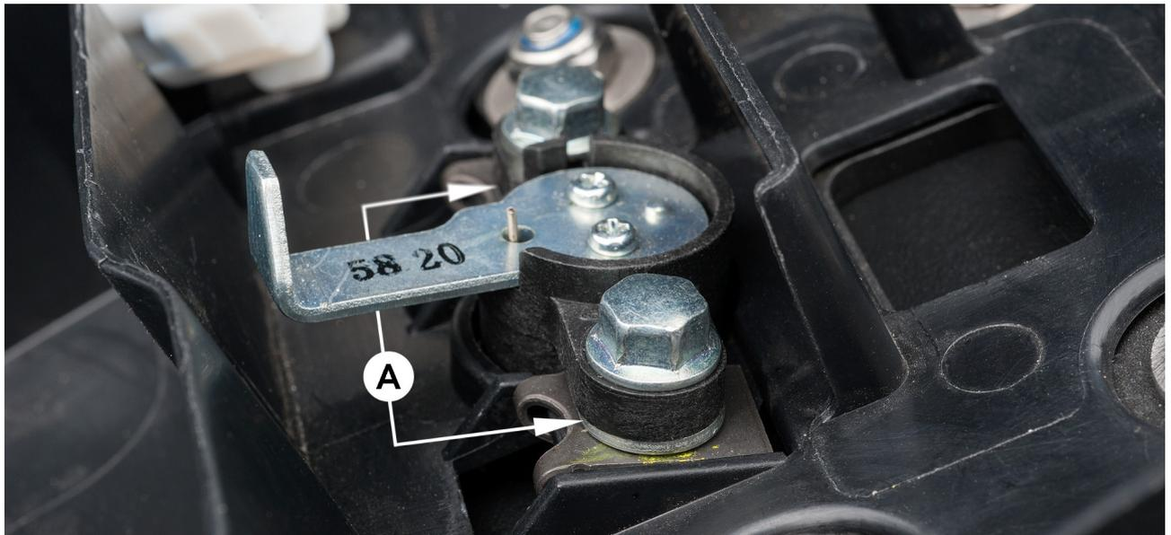
Das Sitzbankschloss durch das Einsetzen der Unterlegscheiben (A) leicht „anheben“.
