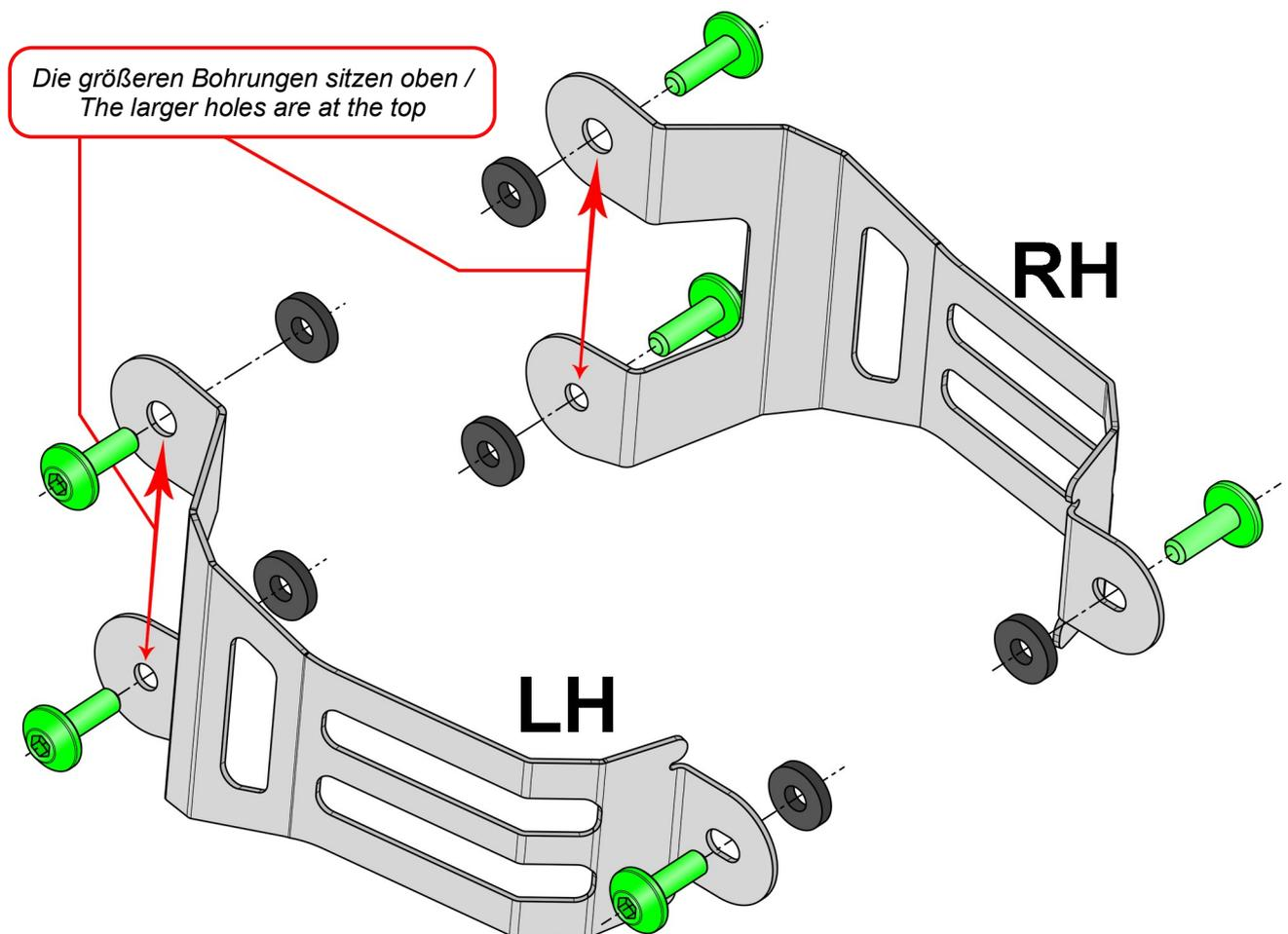
**DE** Die Cover zusammen mit den Gummi-Scheiben – wie gezeigt – auf die OEM-Abdeckungen setzen und mit den OEM-Schrauben (●) montieren.
