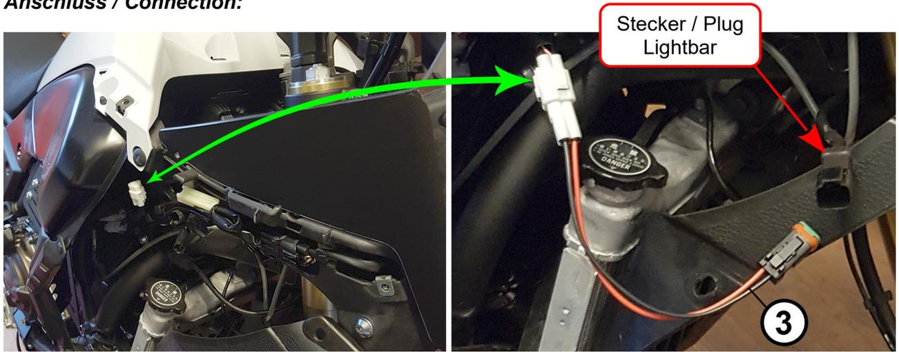
**DE** Unter der rechten Tankverkleidung befindet sich ein 3-poliger Stecker (→). Das Adapterkabel (3) stellt die Verbindung zwischen dem Anschluss-Stecker der Lightbar und diesem Stecker (→) her.
