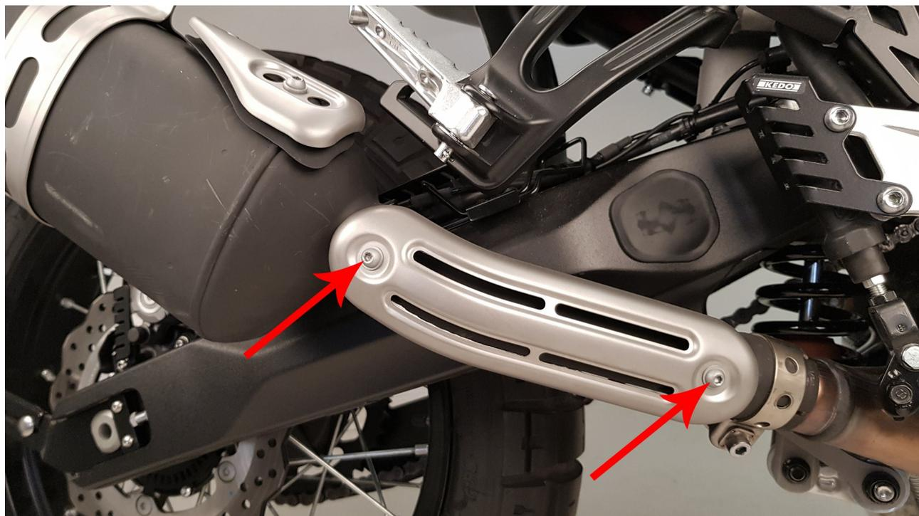
**DE** Die beiden markierten Schrauben (➡) lösen und das Hitzeschutzblech abnehmen.
