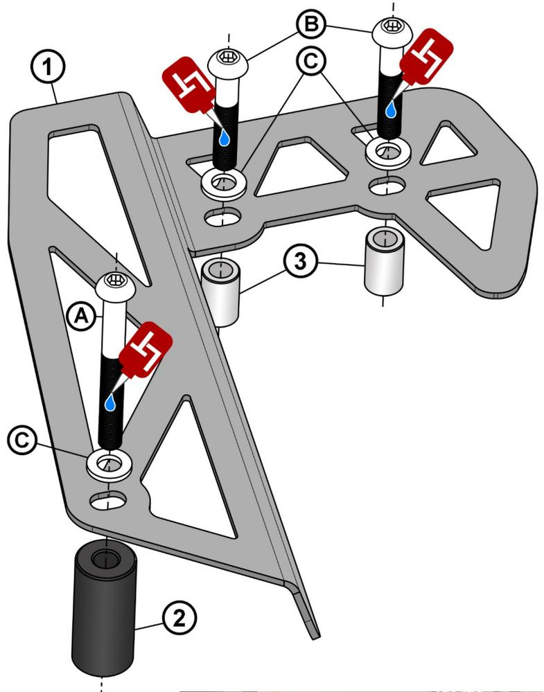
**(DE)** Die rot markierten Schrauben der Ritzelabdeckung lösen.
