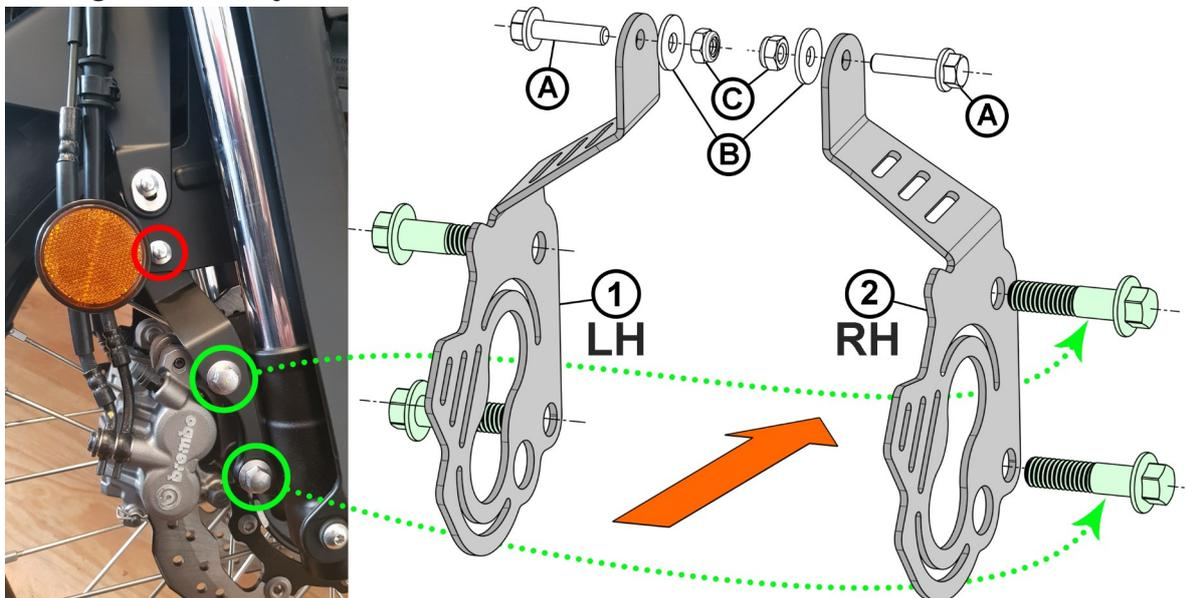
**(DE)** Die markierten Schrauben lösen, die Kotflügel- / Reflektorhalter entfernen und durch die beiden Bremszangen-Abdeckungen (1) und (2) ersetzen.
