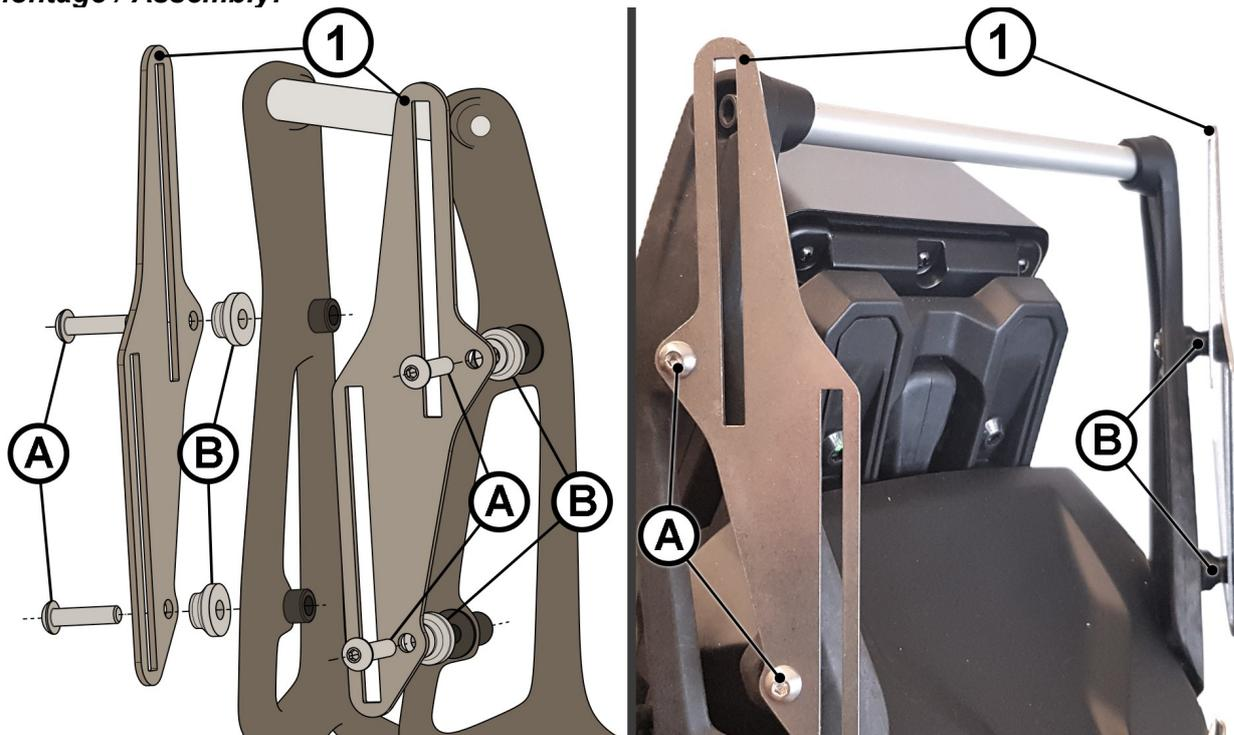
**DE** Die obere Frontscheibe abschrauben, die beiden Adapterbleche (1) auf die Distanzhülsen (B) setzen und mit den Schrauben (A) an den originalen Haltepunkten (Gummidübel) befestigen.
